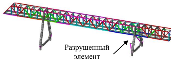
Рис. 8. Схема перегружателя с разрушенным опорным подкосом
